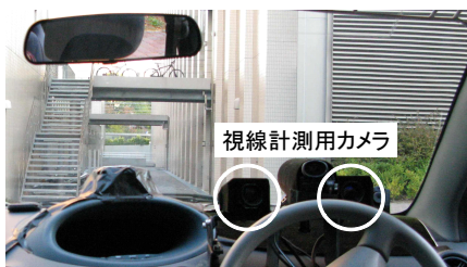
図 6 視線計測用カメラの設置位置
