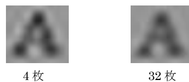
図 6. 用いる低解像度画像枚数に対する超解像処理結果例
