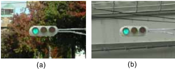
図8. (a) 筐体領域に注目した方が見つけやすい場合と (b) 信号灯領域に注目した方が見つけやすい場合
