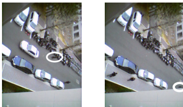
(a) 背景と類似した色の人物 (b)面積の小さな人物 図 7. 領域内追跡失敗例
