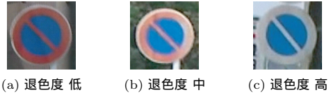
図6 各退色度における基準画像 Fig. 6 Standard images of each discoloration level.
