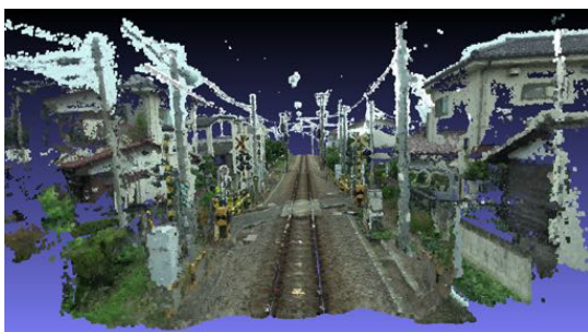
図 1 SfM 法で出力された RGB 値をもつ 3 次元点群の例。 Fig. 1 Example of a 3D point cloud containing RGB values, generated by the SfM method.
